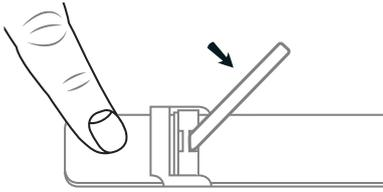
1. Platzieren Sie das Einstellwerkzeug in die Öffnung und heben Sie die Plattenklemme an.
