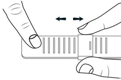
2. Schieben Sie den Verschluss auf der Rückseite in die gewünschte Position, um die Größe des Bandes anzupassen.
